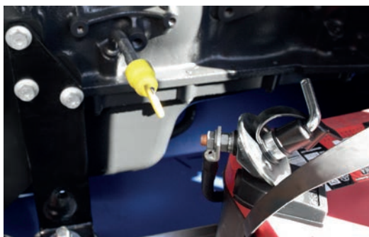
DESCONECTADORES DE BATERIAS
